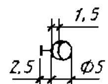
8. Светильник с разрядной лампой высокого давления на опоре для наружного освещения
