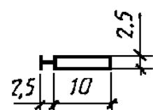
7. Светильник с разрядной лампой высокого давления на кронштейне для наружного освещения
