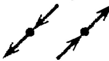
3.3. Проводка пересекает отметку, изображенную на плане, сверху вниз или снизу вверх и не имеет горизонтальных участков в пределах данного плана
